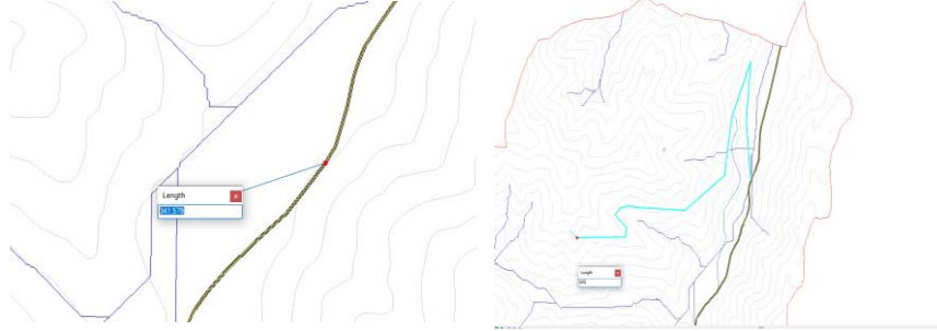
Şekil 9. Pergel açıklığı kullanılarak sıfır hattının çizimi
