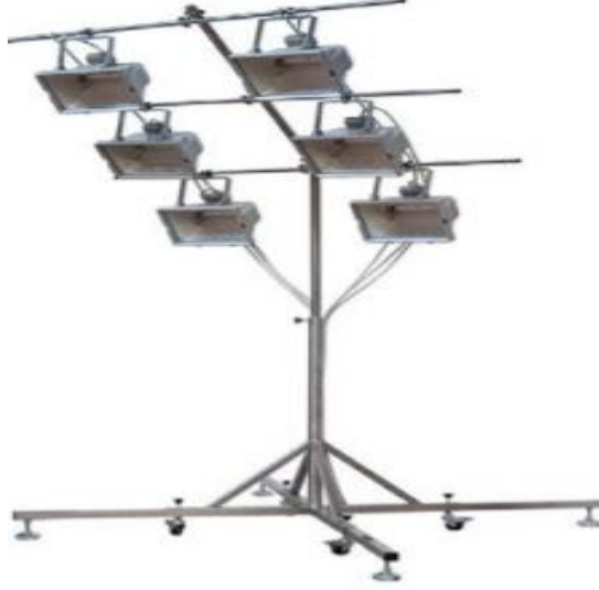
Şekil 9. Fotovoltaik Sistem İçin İç Ortam Aydınlatma Sistemi
