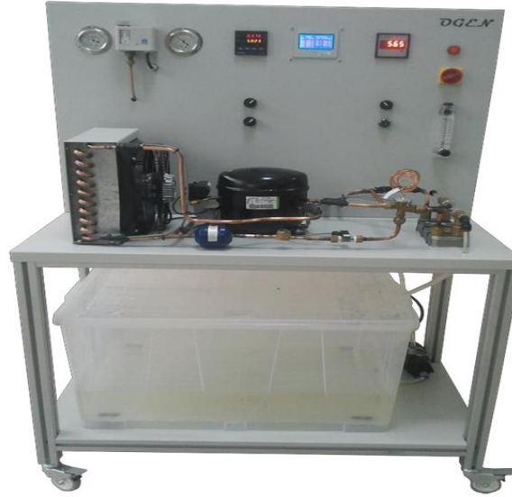
Şekil 16. Isı pompası deney seti
