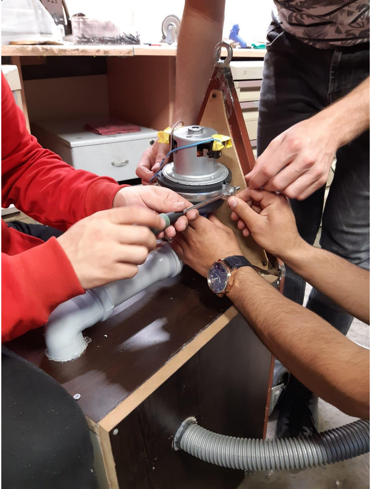
Şekil 5. Motorun şasiye montajı
