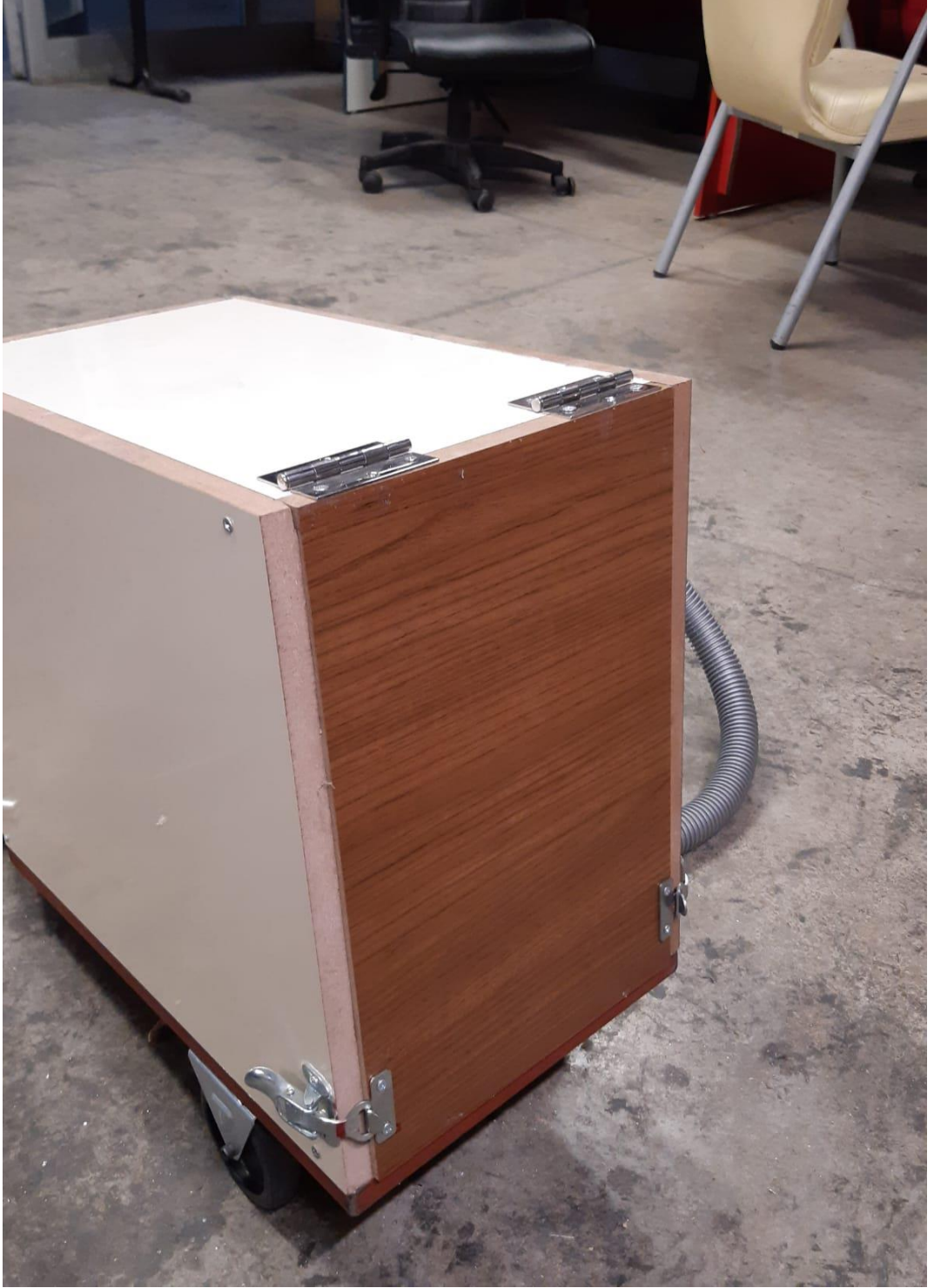
Şekil 6. Konteyner arka kapak bağlantıları
